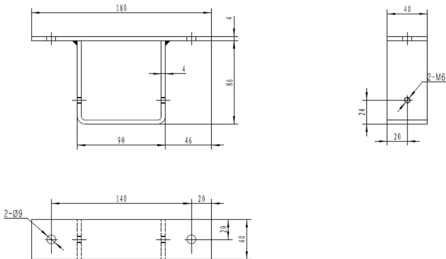
图示 4 背光器安装架
