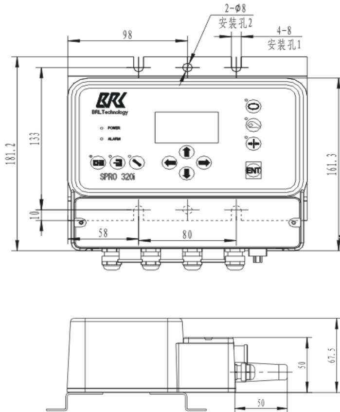
图示 5 控制器安装尺寸图
