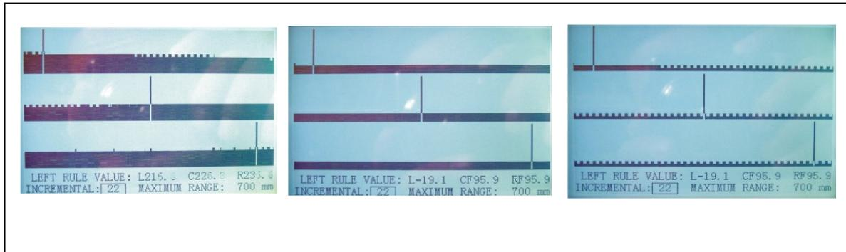
调整 CCD 传感器焦距时，可在标尺位置放置一根直径 1mm 细丝，调整焦距使细丝显示最清晰，其影像应与上图 8 中边界竖线相似。
