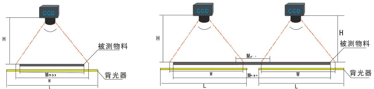
H = 被测物料到传感器的距离； W = 传感器检测范围；  $M_{max}$  = 最大物料宽度；
