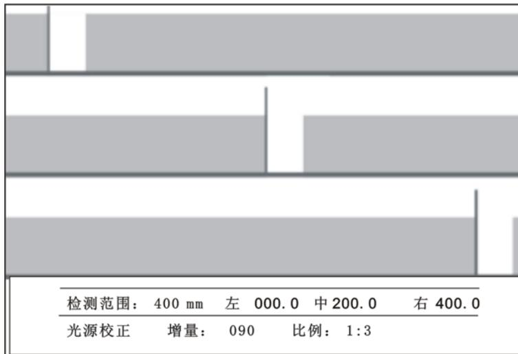
上图为标尺校正界面，如果是第一次校正，应该先进入基础矫正界面进行光源矫正，光源矫正准确后，可以进行标尺矫正，否则，标尺的三点数据不能正常显示。
