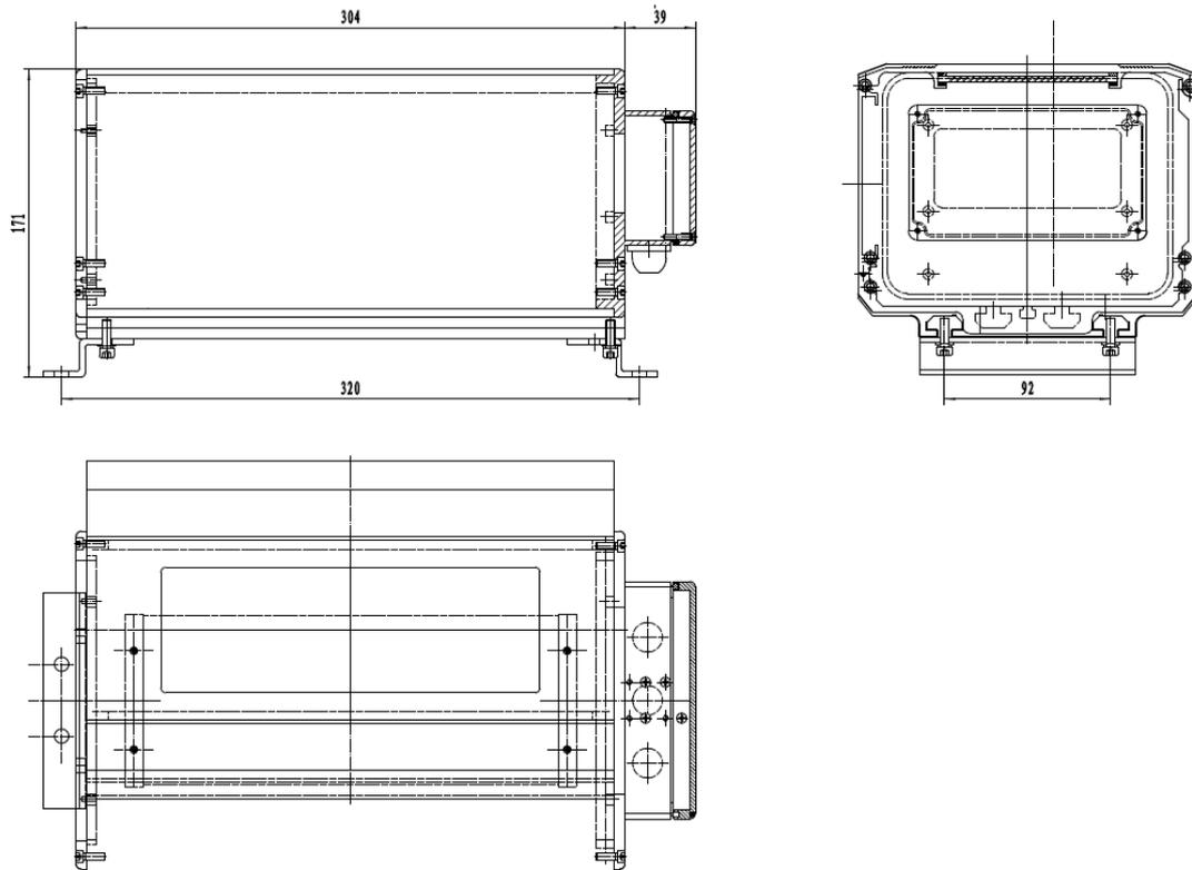
图示 6 大显示安装尺寸图
