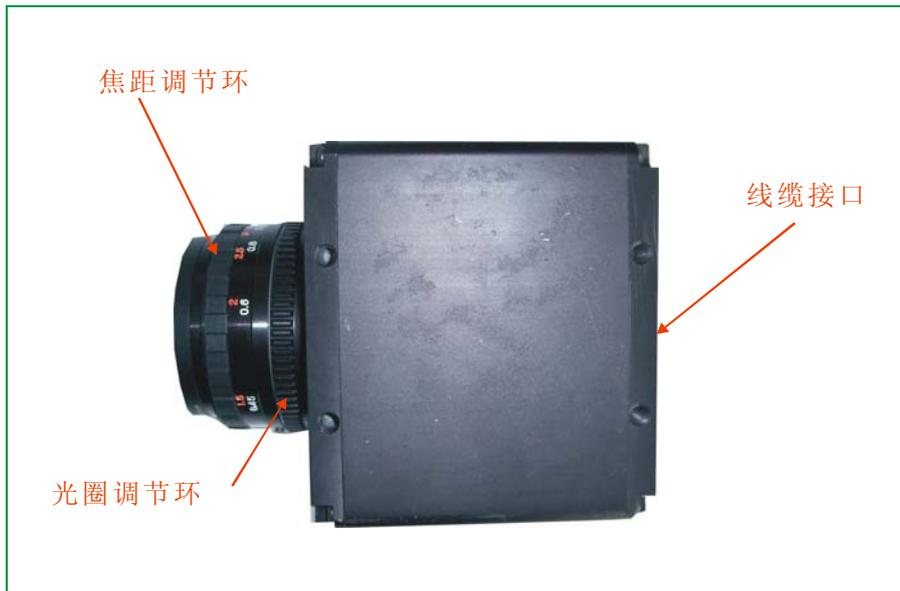
**焦距调节环:** 调节传感器镜头焦距, 使物体成像清晰 .
